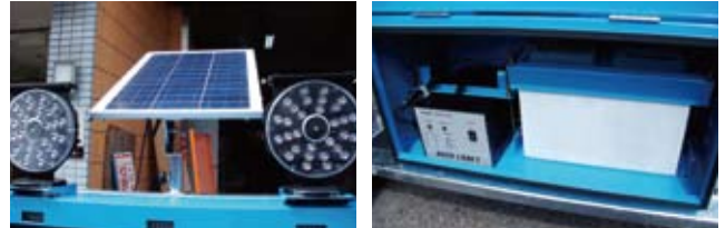
50Wのソーラーパネル使用。無日照約12日間。充電器付きなので、100Vで強制充電可能。
