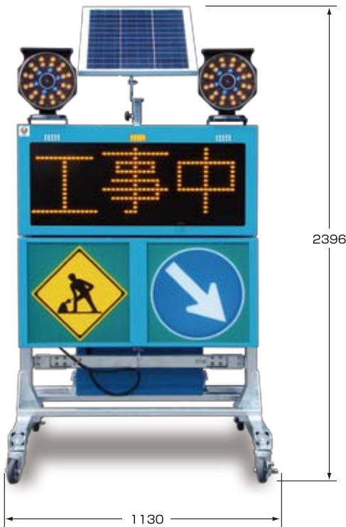
50Wのソーラーパネル使用。無日照約12日間。充電器付きなので、100Vで強制充電可能。
